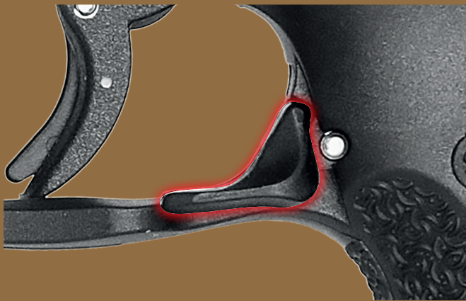
Abb. 6 und 7: Lediglich das Griffstück unterscheidet sich je nach Magazin-Auslösenmechanismus per Wippe (links) oder Druckknopf (rechts) – alle anderen Bau- und Zubehörteile, insbesondere die Magazine selbst – sind beliebig austauschbar bzw. identisch. Hinzu kommt, dass die SFP9-Familie das P30-Magazin ohne Modifikationen verwendet. Somit können bei Ablösung der P30 durch die SFP9 enorme Kosten für (Reserve)magazine eingespart werden.
