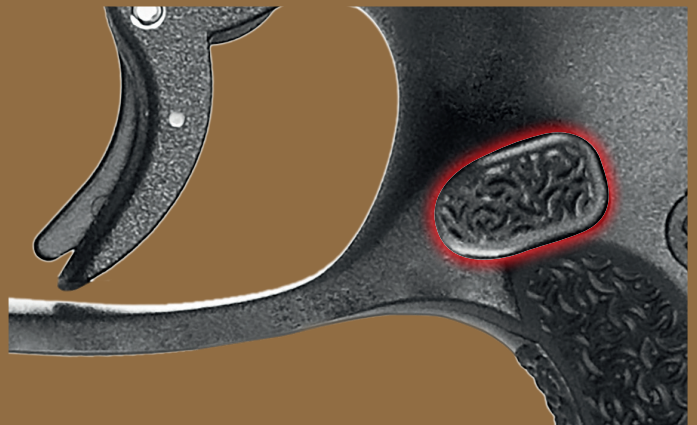
Abb. 6 und 7: Lediglich das Griffstück unterscheidet sich je nach Magazin-Auslösenmechanismus per Wippe (links) oder Druckknopf (rechts) – alle anderen Bau- und Zubehörteile, insbesondere die Magazine selbst – sind beliebig austauschbar bzw. identisch. Hinzu kommt, dass die SFP9-Familie das P30-Magazin ohne Modifikationen verwendet. Somit können bei Ablösung der P30 durch die SFP9 enorme Kosten für (Reserve)magazine eingespart werden.
